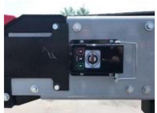
Fig. 3-2 La válvula de control en el morro de la cinta transportadora EXT-52 permite recibir una persona para controlar el flujo de material.
