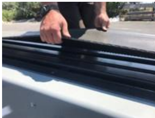
Fig 4-2 La tensión de la cinta de la cinta transportadora es correcta cuando la cinta puede levantarse entre 4 y 6 pulgadas en el centro de la cinta transportadora.
